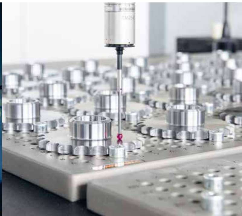
Misurazione del pignone 3D
