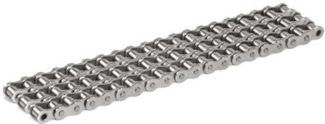
Toutes les chaînes à rouleaux Donghua SLR sont fabriquées avec des axes nickelés chimiquement et des douilles en acier durci par frittage. Ces composants sont autolubrifiants. Toutes les autres pièces sont nickelées et protégées contre la rouille. Les chaînes à rouleaux Donghua SLR sont utilisées dans des applications où la maintenance n'est pas possible. La re-lubrification n'est pas nécessaire et n'est pas recommandée. L'extérieur de ces chaînes à rouleaux SLR est sec.
