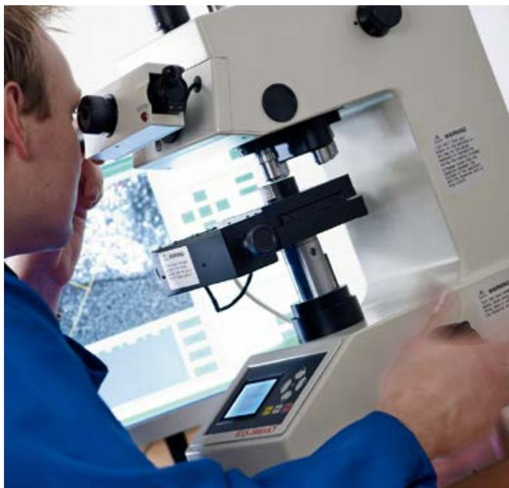
Essai de micro dureté
